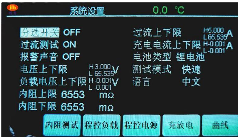
设置完成后, 按“内阻测试”按键, 返回到内阻测试界面, 则会出现过流测试参数,
